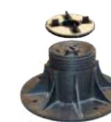
Der Sockel besteht aus 2 Teilen, der Basis und der Schraube zur Höhenverstellung. Auf diesen Sockel wird der Kreuzkopf mit integriertem Fugenabstand von 4mm aufgesetzt.
