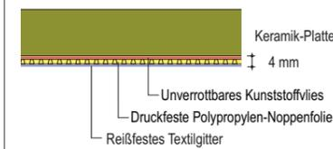
Unsere entkoppelte Systemlösung, besteht aus einem unverrottbaren Kunststoffvlies, einer Noppenfolie aus druckfestem Polypropylen und einem aufkaschierten Textilgitter. Alle Komponenten werden mittels hochvergütetem Industriekleber direkt auf die Keramik-Fliese aufgebracht und sorgen so für eine extrem haltbare und gleichzeitig flexible Verbindung zwischen Betonkörper und Keramik-Fliese.
