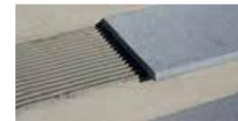
**i** Abdeckplatten in Naturstein-Oberflächen immer vollflächig mit Zahnpachtel (Zahnung 10 mm) verlegen. Alle Stoßfugen sind mit Dehnfuge elastisch auszubilden, ebenso alle Anschlussfugen.
