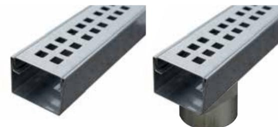
Die formschöne und einfache Lösung für die Entwässerung der Gartendusche. Ohne Stemmarbeiten, einfach gemeinsam mit den Platten verlegt. Ein vorgestanzt Bodenablauf Dm. 30 mm ist in jeder Rinne vorhanden. Dort wo benötigt, wird die Öffnung einfach mit der Zange heraus gebrochen. Alternative ist die Ablaufrinne mit integriertem Ablauf mit 30 mm Durchmesser. Edelstahl-Werkstoff 1.4301
