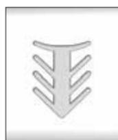
Keine offene Fugen in denen sich Schmutz und Ungeziefer sammeln. Einfach Dichtkleber in die Fugen einbringen, Fugenband hineindrücken, mit einer Schere leicht ablängbar. Elastisches Silikon-Kautschukprofil für ca. 3 - 4 mm Fugenbreite, alterungs- und witterungsbeständig, UV-beständig und ozonfest.
