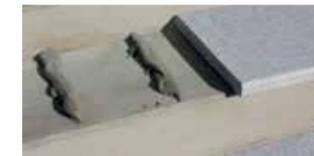
**i** Stufenplatten in LeichtRein-Oberflächen immer auf Mörtelbändern verlegen um temperaturbedingte Spannungen auszugleichen (Auftreten von Spannungsrissen). Alle Stoßfugen sind mit Dehnfuge elastisch auszubilden, ebenso alle Anschlussfugen. Beachten Sie bitte, dass es bei einer Kombination von Profi-Produkten und Exklusiv-Produkten zu Farb- und Strukturunterschieden kommen kann.
