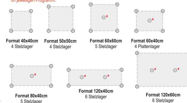
\* = bei den als Mittelstütze dienenden Stelzlager sind die Fugenkreuze an den Sollbruchstellen abzubrechen
