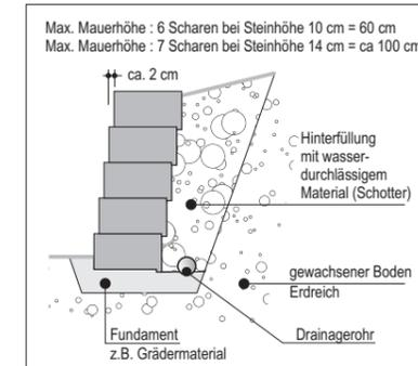
Der hinten, an der Unterseite des Steines befindliche Verzahnungs-Steg ergibt automatisch die immer gleichmäßige Wandneigung (ca. 2 cm pro Lage) und sorgt für die sichere Stabilität der Mauer. Schichten Sie die Steine einfach trocken übereinander. Als Unterbau reicht eine Schicht Gräbermaterial.
