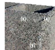
Baumeistersteine weisen produktionsbedingt, mehr oder weniger ausgeprägte „Grate“ = Betonreste siehe (x) auf den Kanten und Fasen auf. Diese können einfach im Zuge des Aufbaus entfernt (weggewischt) werden. Diese Betonreste sind unumgänglicher Bestandteil des preiswerten Produktionsverfahrens. Wenn Sie diese nicht akzeptieren können, wählen Sie einen Zaunstein mit aufwändigeren, geschliffenen Kanten und Fasen. Eventuelle Scheuerspuren siehe (y) verschwinden durch die Bewitterung von alleine.
