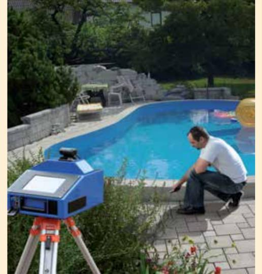
Komplizierte Abdeckungen, Stufenanlagen oder Poolränder werden von unserem Außendienst mit einem 3D-Messgerät digital vermessen.
