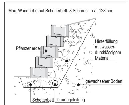
Höhere Böschungssicherungen können nur nach Beurteilung eines Fachmannes vor Ort / nach statischer Berechnung durchgeführt werden.
