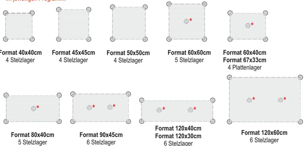
\* = bei den als Mittelstütze dienenden Stelzlager sind die Fugenkreuze an den Sollbruchstellen abzubereiten
