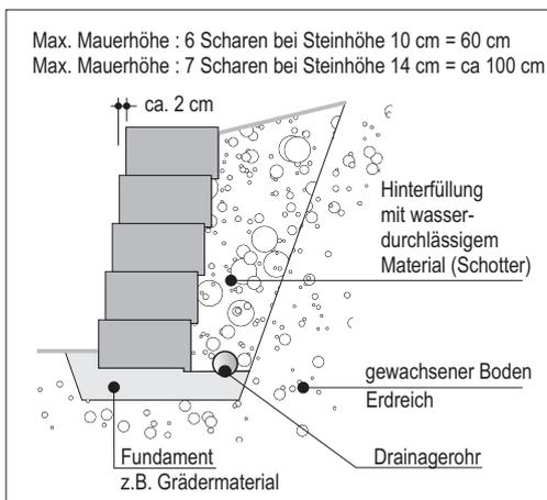
Der hinten, an der Unterseite des Steines befindliche Verzahnungs-Steg ergibt automatisch die immer gleichmäßige Wandneigung (ca. 2 cm pro Lage) und sorgt für die sichere Stabilität der Mauer. Schichten Sie die Steine einfach trocken übereinander. Als Unterbau reicht eine Schicht Grädematerial.
