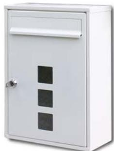
Der **Postkasten** (Breite 28 cm, Höhe 40 cm, Tiefe 12 cm) in massiver und haltbarer Ausführung - Stahlblech (Kasten 0,75 mm, Entnahmetür 1 mm dick!), feuerverzinkt und zusätzlich pulverbeschichtet. Mit Einwurfsklappe und Postentnahme nach vorne bzw. Schloss mit zwei Schlüsseln.
