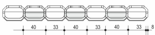
Für den geraden Abschluss: Stein selbst zuschneiden (einfach und leicht mit Trennscheibe)
