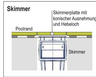
Mit modernsten Maschinen wird ein Deckel geschliffen, der durch seine konische Ausführung mit Hebeloch für eine optimale Bedienung sorgt. Beachten Sie bitte dass der Abstand zwischen Poolrandplatten-Kante und Skimmerdeckel mind. 5 cm betragen muß.
