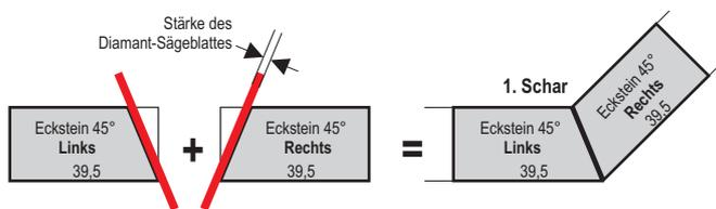
Die Fuge zwischen den einzelnen Formsteinen schließen Sie im Zuge des Aufbaues einfach mit Dichtkleber.
