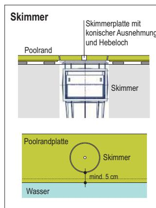
Mit modernsten Maschinen wird ein Deckel geschnitten, der durch seine konische Ausführung mit Hebeloch für eine optimale Bedienung sorgt.
