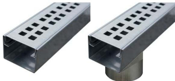
Die formschöne und einfache Lösung für die Entwässerung der Gartendusche. Ohne Stemmarbeiten, einfach gemeinsam mit den Platten verlegt. Ein vorgestanzter Bodenablauf Dm. 30 mm ist in jeder Rinne vorhanden. Dort wo benötigt, wird die Öffnung einfach mit der Zange heraus gebrochen. Alternative ist die Ablaufrinne mit integrierten Ablauf mit 30 mm Durchmesser.
