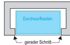
Der für den Einbau benötigte Steinzuschnitt (gerader Schnitt / kein Anschlag) kann einfach bauseits durchgeführt werden. Auf Wunsch auch werkseitig, Lieferzeit 1 Woche, Aufpreis für die Zuschnitte an 3 Steinen € 69,60
