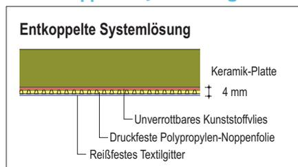
Unsere entkoppelte Systemlösung, besteht aus einem unverrottbaren Kunststoffvlies, einer Noppenfolie aus druckfestem Polypropylen und einem aufkaschierten Textilgitter. Alle Komponenten werden mittels hochvergütetem Industriekleber direkt auf die Keramik-Fliese aufgebracht und sorgen so für eine extrem haltbare und gleichzeitig flexible Verbindung zwischen Betonkörper und Keramik-Fliese.
