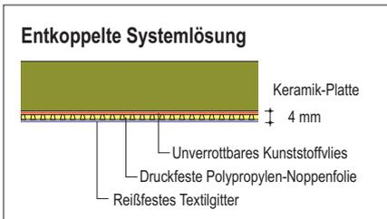
Unsere entkoppelte Systemlösung, besteht aus einem unverrottaren Kunststoffvlies, einer Noppenfolie aus druckfestem Polypropylen und einem aufkaschierten Textilgitter. Alle Komponenten werden mittels hochvergütetem Industriekleber direkt auf die Keramik-Fliese aufgebracht und sorgen so für eine extrem haltbare und gleichzeitig flexible Verbindung zwischen Betonkörper und Keramik-Fliese.
