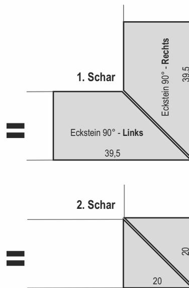
Die Fuge zwischen den einzelnen Formsteinen schließen Sie im Zuge des Aufbaues einfach mit Dichtkleber.
