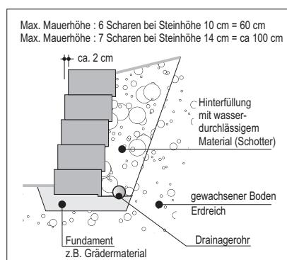
Der hinten, an der Unterseite des Steines befindliche Verzahnungs-Steg ergibt automatisch die immer gleichmäßige Wandneigung (ca. 2 cm pro Lage) und sorgt für die sichere Stabilität der Mauer.
