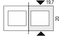
\* = durch eine Sägeblattstärke von 0,6 cm verbleibt beim Schnitt durch den Normalstein die Breite von 19,7 cm für den Halbstein. Wichtig: diese rationelle Art der Herstellung führt in fast allen Fällen zu keinen Problemen beim Aufbau. Für den seltenen Fall, das zwei halbe Steine genau das Maß eines ganzen Steines ergeben müssen, schneiden wir diese Steine speziell für Sie.
