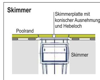
Mit modernsten Maschinen wird ein Deckel geschlitten, der durch seine konische Ausführung mit Hebeloch für eine optimale Bedienung sorgt. Beachten Sie bitte dass der Abstand zwischen Poolrandplatten-Kante und Skimmerdeckel mind. 5 cm betragen muß.
