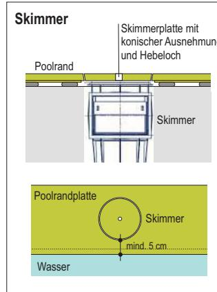
Mit modernsten Maschinen wird ein Deckel geschnitten, der durch seine konische Ausführung mit Hebelöch für eine optimale Bedienung sorgt.
