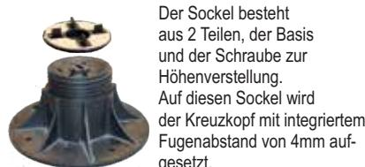
Der Sockel besteht aus 2 Teilen, der Basis und der Schraube zur Höhenverstellung. Auf diesen Sockel wird der Kreuzkopf mit integriertem Fugenabstand von 4mm aufgesetzt.
