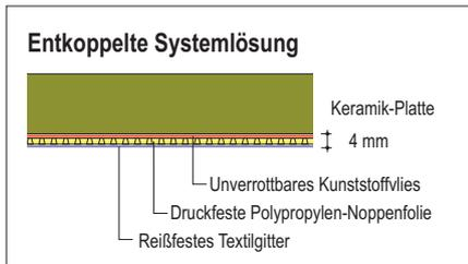
Unsere entkoppelte Systemlösung, besteht aus einem unverrottbaren Kunststoffvlies, einer Noppenfolie aus druckfestem Polypropylen und einem aufkaschierten Textilgitter. Alle Komponenten werden mittels hochvergütetem Industriekleber direkt auf die Keramik-Fliese aufgebracht und sorgen so für eine extrem haltbare und gleichzeitig flexible Verbindung zwischen Betonkörper und Keramik-Fliese.
